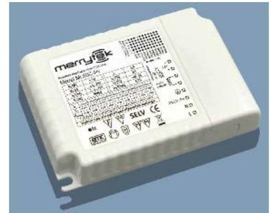
Mit diesem Multifunktionstreiber kann man den Ausgangsstrom und die Spannungen über spezielle DIP-Schalter einstellen. Ausgangsspannungen können zwischen 12 und 24V gewählt werden. Verschiedene Ausgangsströme von 350mA bis 1050 mA (wählbar) sind einstellbar. Bei den Konstantspannungen (12V / 24V) fließen immer 1050mA. Man kann eine daran angeschlossene Leuchte primär (Betriebsspannung 230 VAC) oder sekundär von 0-10 V dimmen. Auch über einen Taster kann gedimmt werden (siehe Abbildung C)
