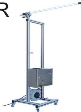
Das Gerät LUDES AIR MOBILE besteht aus einer UV-Lampe mit Splitterschutz, welche auf einem robusten, fahr- und schwenkbaren Gestell montiert ist. Die Desinfektionseinheit kann mit einer Fernbedienung an- und ausgeschaltet werden. Das Gerät eignet sich hervorragend für die Desinfektion in bestehenden Reinraumanlagen.
